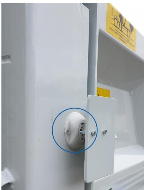
D'un point de vue technique, la solution de détection d'ouverture des ridelles de camions à bennes hydrauliques s'appuie sur une **infrastructure extrêmement légère**, constituée de capteurs magnétiques et d'aimants, associés au boîtier ATLAS Connect d'Electro Maintenance.
